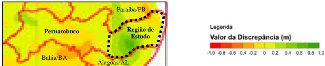
Figura 1 – Mapa de discrepâncias entre o modelo de ondulação geoidal e os pontos GPS/RRNN (IBGE, 2013).
